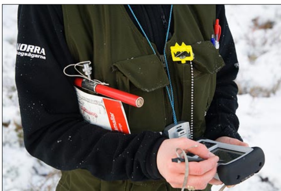
En planläggare behöver en hel del verktyg; handdator, tillväxtborr, relaskop, höjdmätare och mycket annat.
